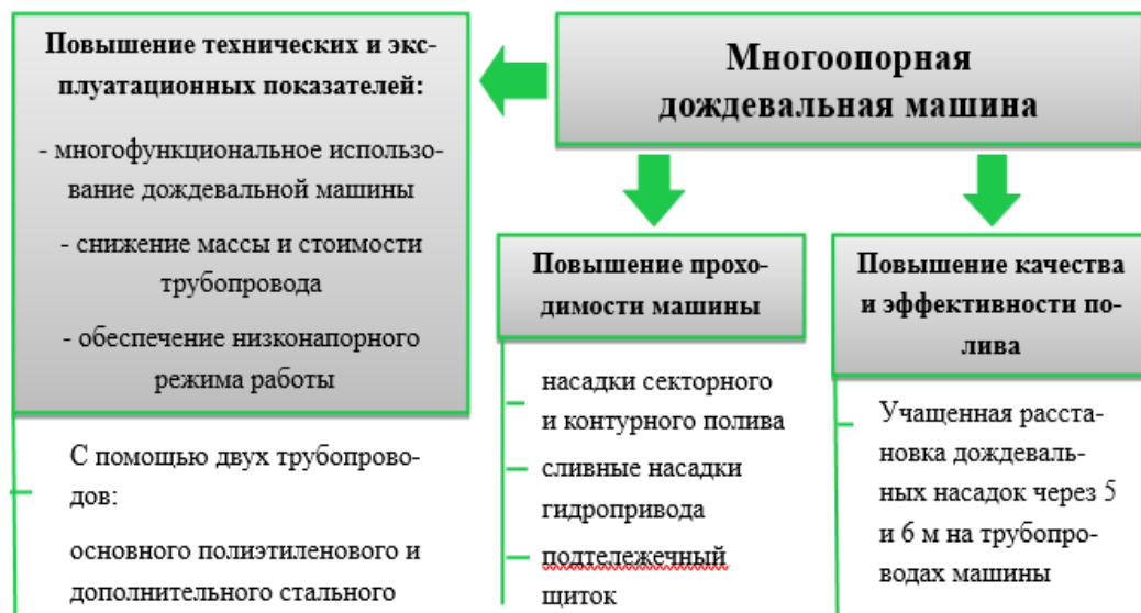
Рисунок 1 – Основные направления совершенствования многоопорных дождевальных машин
