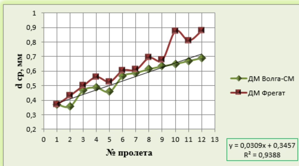
Рисунок 9 – Изменение среднего диаметра капель дождя вдоль трубопровода ДМ «Волга-СМ» и «Фрегат»
