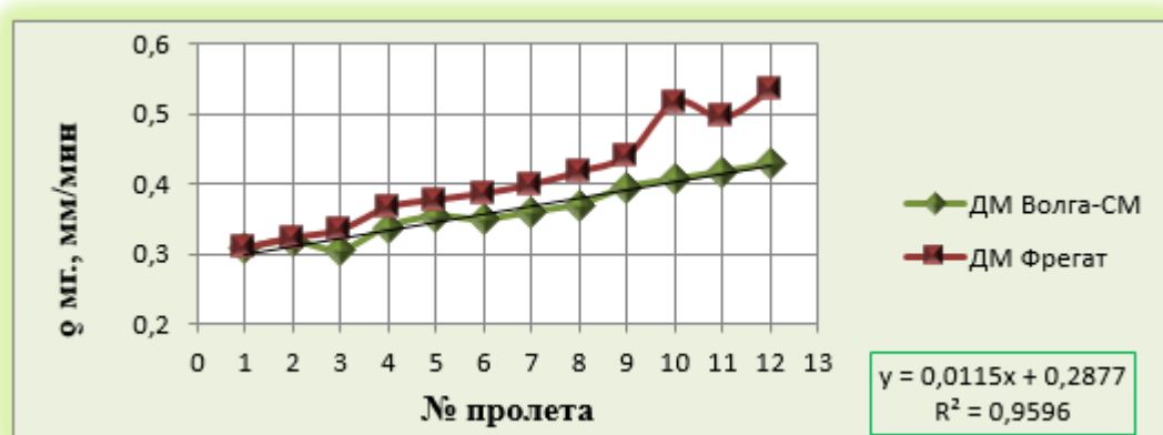
Рисунок 8 – Изменение средней мгновенной интенсивности дождя вдоль трубопровода ДМ «Волга-СМ» и «Фрегат»
